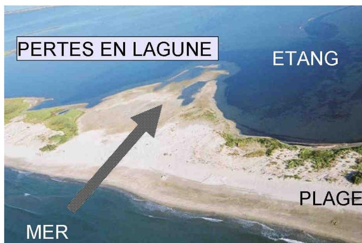
FIG. I.7 – Schématisation du transport de sédiment par submersion.
