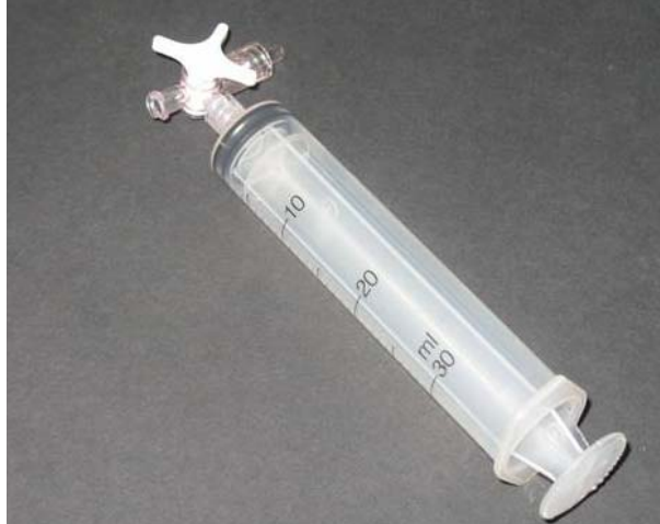
Figure 3-3 Photo de la seringue contenant l'hélium-3 hyperpolarisé et du robinet utilisé qui sera fermé lors du transport vers l'imageur.
