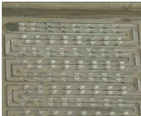
Figure I - 22 : Plaque bipolaire métallique
