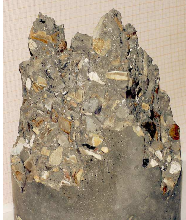
Fig. 2.22: Faciès de rupture d'un béton en compression (Département de Génie Civil)
