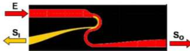
Figure VII.3 : Schéma du dispositif S . Le premier demi-coude est large de 200\mu\text{m} avec un rayon de courbure de 200 à 400\mu\text{m} .
