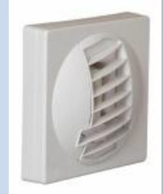
Bouche d'extraction autoréglable 45/135 m 3 /h sous 50-150 Pa
