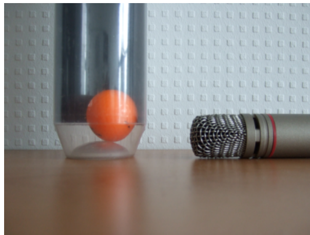
FIG. 3.13 – Dispositif de synchronisation des données de stéréovision avec l'audio. Lorsque la balle de golf heurte le fond, le son est enregistré par le microphone. L'événement est aussi filmé par les caméras de stéréovision.
