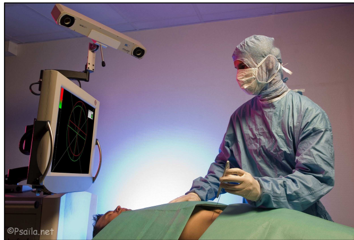
Fig. 3. Le chirurgien focalise son attention sur les informations inscrites sur l'écran face à lui, prêt à donner la bonne orientation à l'outil afin de l'insérer en ligne droite jusqu'à la cible. La caméra au dessus de l'écran localise les positions de la cible et de l'aiguille à l'intérieur du corps.
