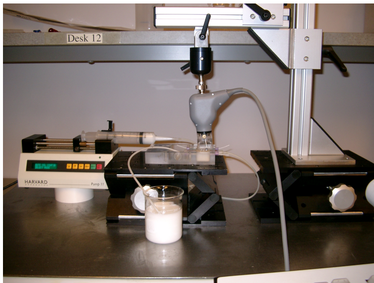
FIG. 5.1 – Dispositif expérimental. Le pousse-seringue est utilisé pour gérer le flux au sein du vaisseau.
