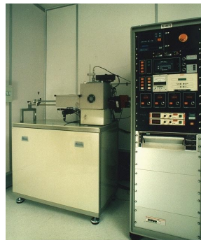
Figure 2-106: Machine de gravure ionique réactive, MG 200
