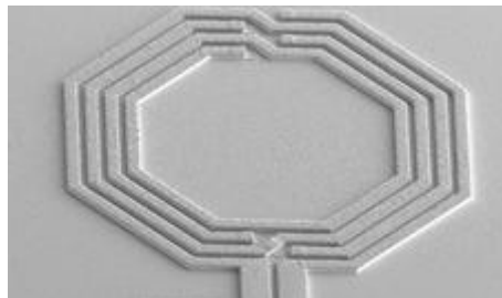
Figure 1-11: Exemple d'inductance réalisée sur PICS
