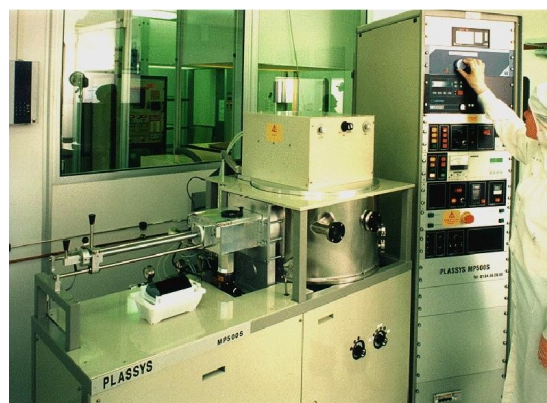
Figure 2-109: Machine de pulvérisation cathodique, MP 500 S
