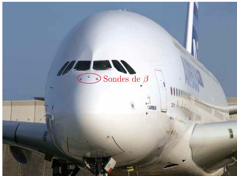
FIG. 7.1: Emplacement des sondes de dérapiage sur l'A380
