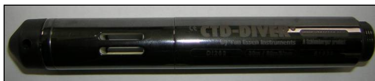
Figure 168. CTD Diver utilisé dans la source sous-marine, dans les forages et dans les sources.
