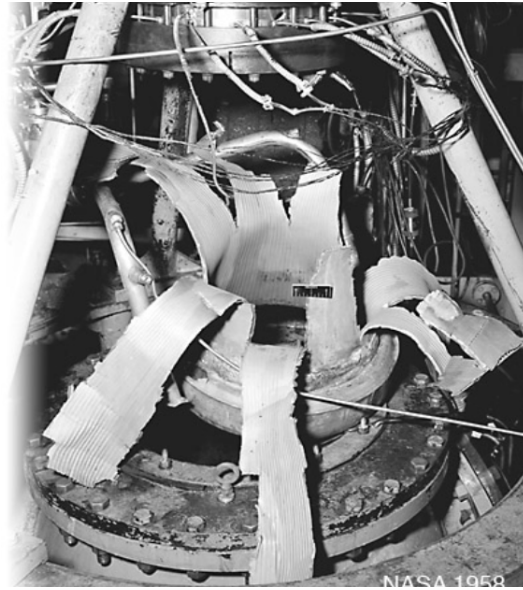
FIG. 1.2 - Chambre détruite suite à une instabilité de combustion (avec la permission de la NASA).
