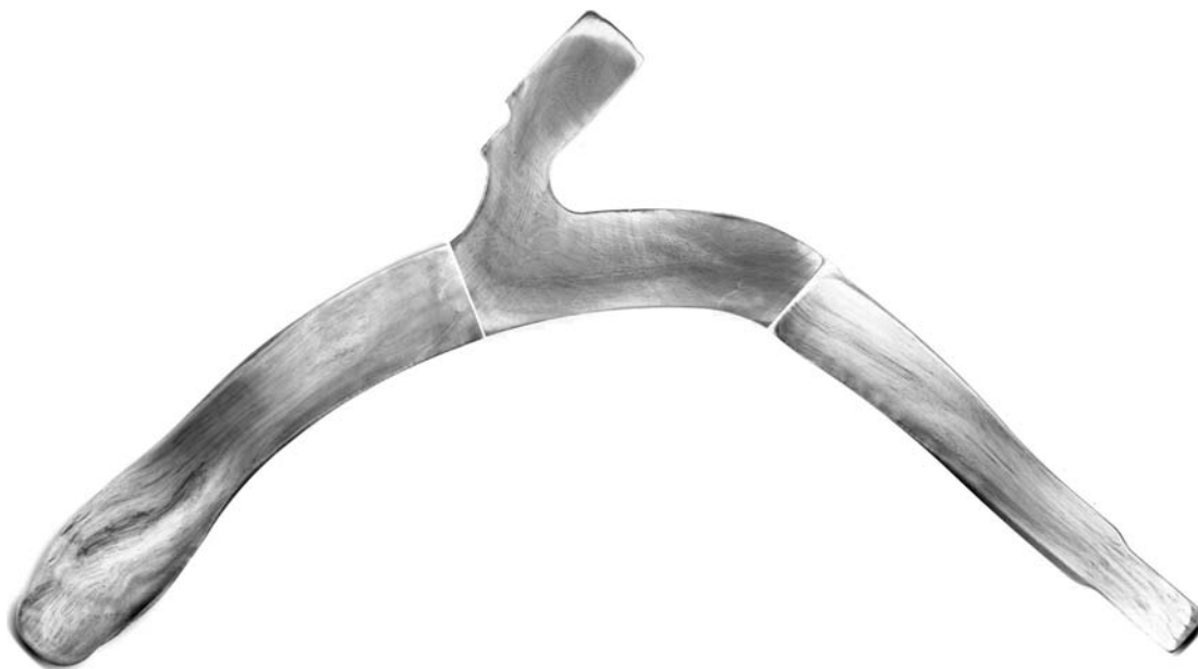
Figure 3.4 : Fibrage obtenu par attaque chimique
