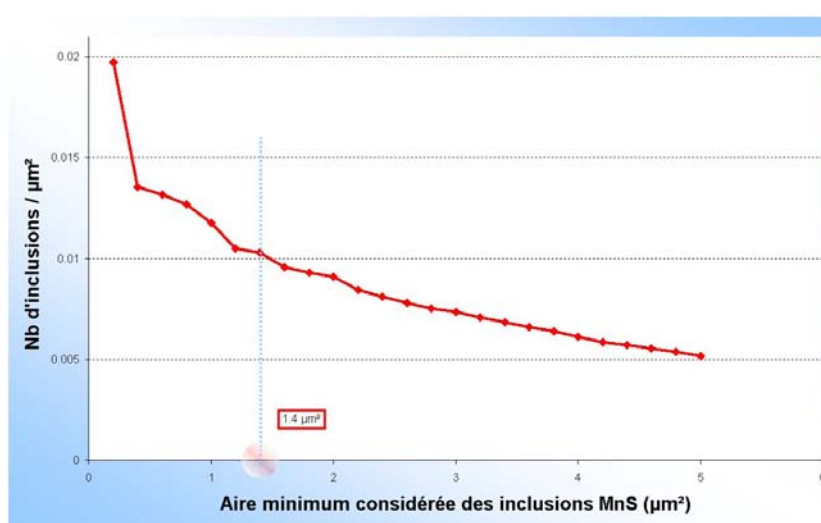
Figure 4.29 : Influence de l'aire des inclusions considérées sur leur nombre : exemple de l'échantillon 1 appartenant au bras sollicité
