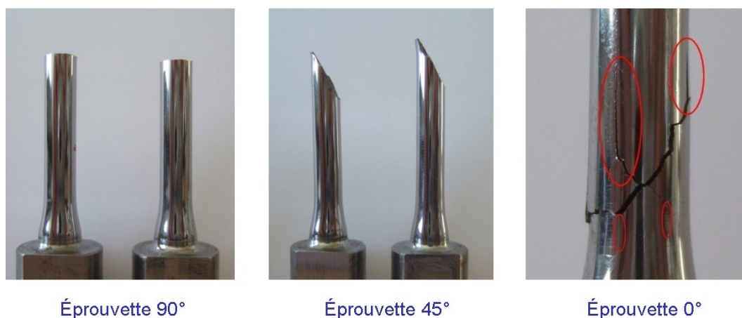
Figure 3.39 : Macrographie du faciès de rupture des éprouvettes prélevées à 0^\circ , 45^\circ et 90^\circ par rapport au fibrage et sollicitées en torsion alternée
