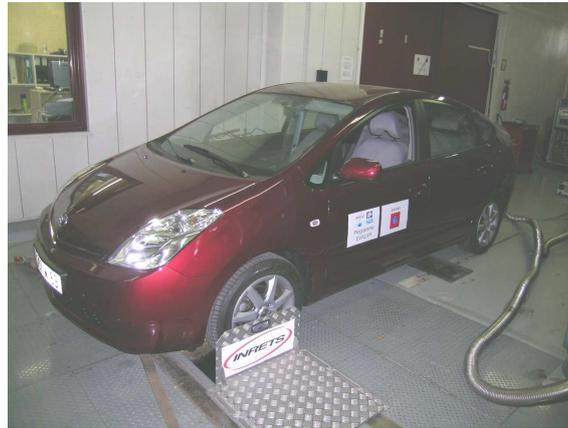
FIG. 11.1 – Toyota Prius sur le banc à roulement avec système de récupération des gaz d'échappement de l'analyseur de gaz.
