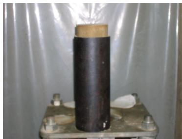
Figure 5.8 : Moule de compactage des éprouvettes cylindriques
