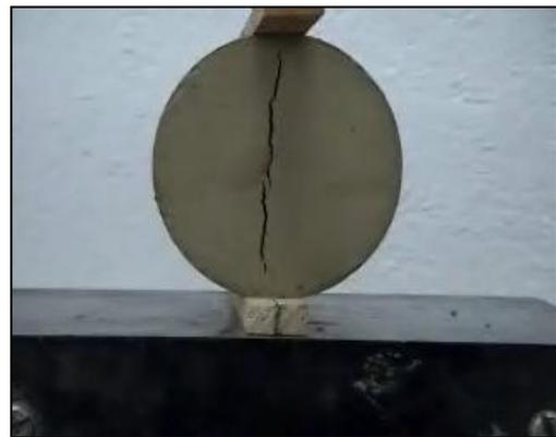
Figure 5.24b : Rupture de l'éprouvette à la vitesse 1mm/min
