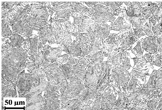
Figure II.2 : Microstructure ferrito-bainitique obtenue par refroidissement en deux étapes après austénitisation à 1070°C, attaque au nital 2% (Microscopie optique).
