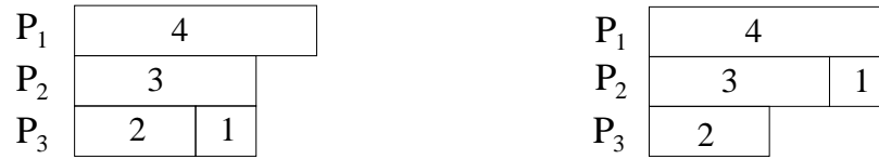
FIG. 5.9 – Gauche : un ordonnancement optimal correspondant à une affectation possible des tâches retournée par OPT\_no\_jump . Droite : ordonnancement optimal qu'il n'est pas possible d'obtenir avec OPT\_no\_jump .
