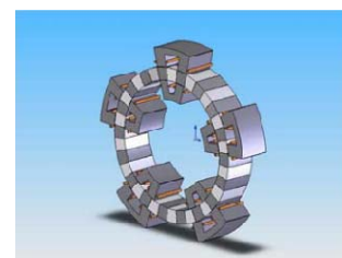
Figure 36: exemple demachine à plot pentaphasée [50]
