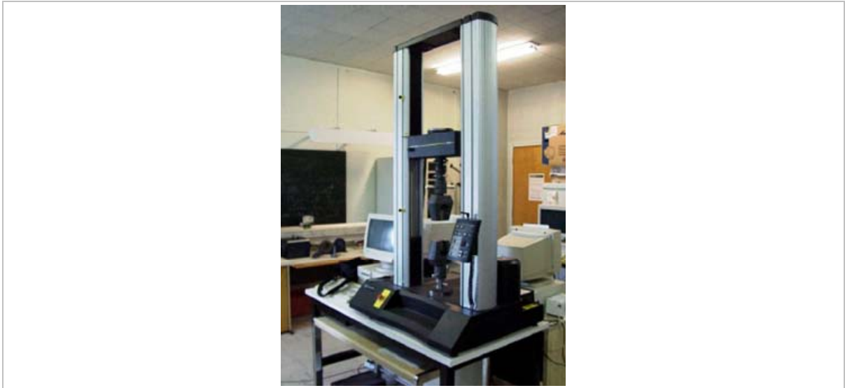
Figure 2-3 : Machine d'essai de traction Instron, capacité 50kN.
