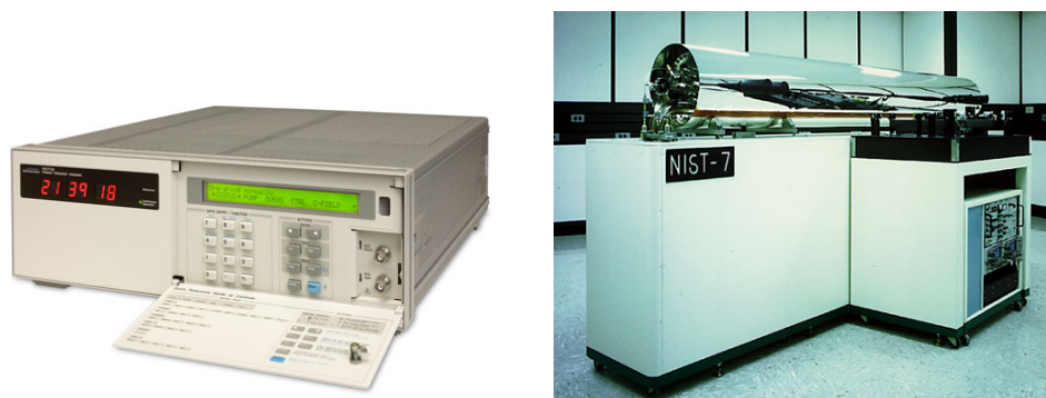
FIG. A.1 – Photos de différentes horloges à jet thermique. A gauche: l'horloge commercial 5071A. A droite: le jet thermique de laboratoire NIST-7
