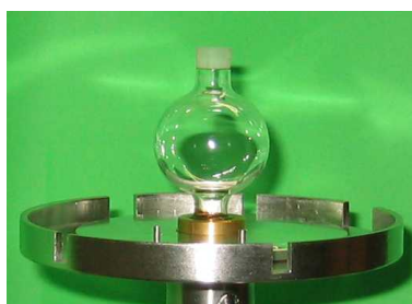
FIG. 3.1 – Photo du ballon de quartz monté sur l'enceinte à vide
