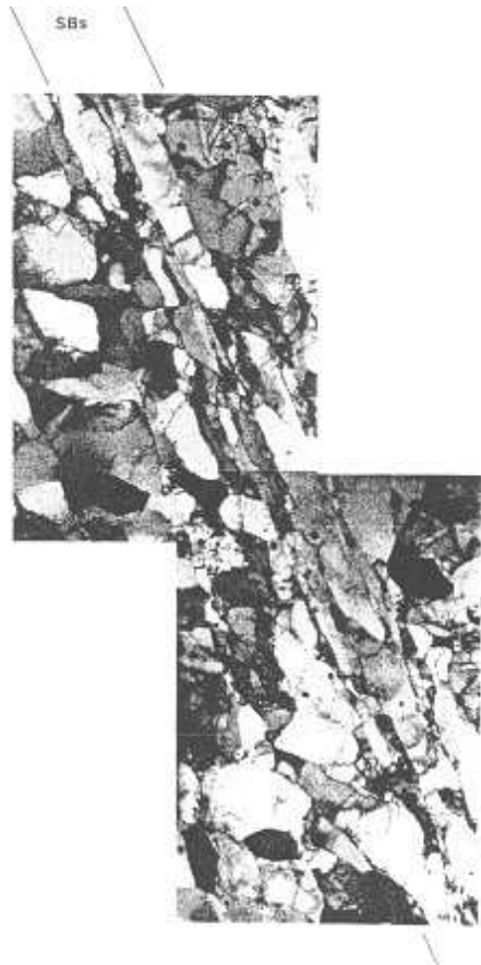
Figure I.8 - Microstructure observée par MET : a) aluminium pur après 30% de réduction par laminage (d'après Bay et al. [1989]), b) aluminium pur après un cycle de déformation (d'après Korbel et Richert [1985]).
