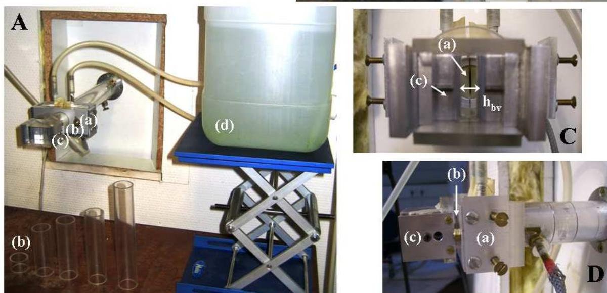
FIG. 4.8 – Photographies de la maquette déformable auto-oscillante de cordes vocales couplée à la maquette rigide statique de bandes ventriculaires. A : vue d'ensemble du dispositif; B : vue de dessus; C : vue de face; D : vue de profil.
