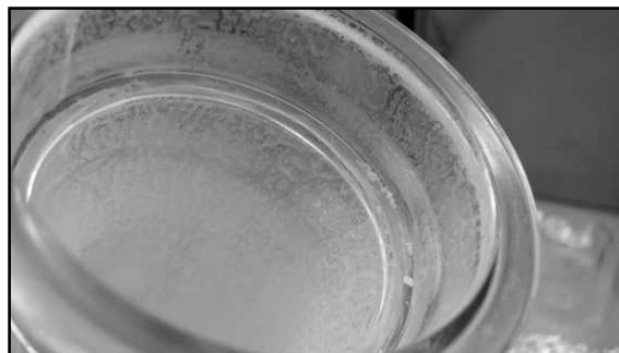
Figure IV.9 : Photographie des parois du réacteur enduites de particules de silice
