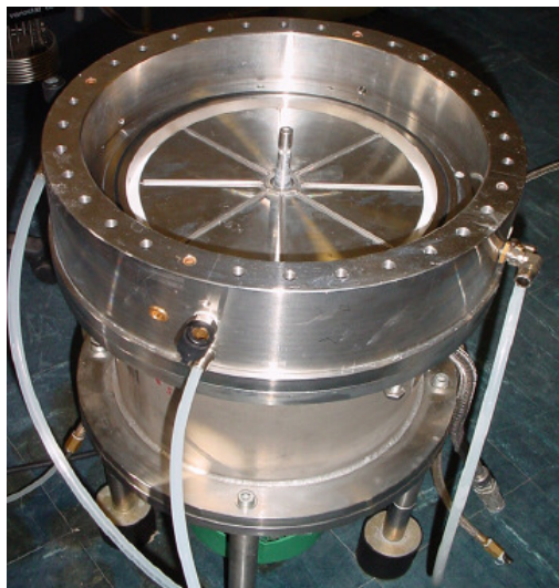
Figure 2.8 Pilote semi industriel à disque rotatif.
