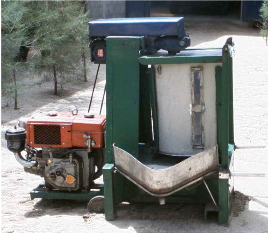
Photo 3.3 : Equipement de production de pâte malléable d'arachide
