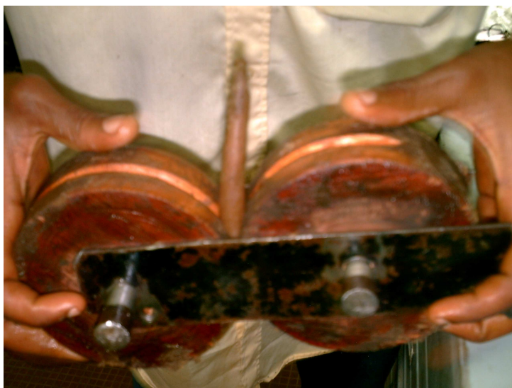
Photo 4.1 : Maquette fonctionnelle principe kluiklui « mettre en forme entre deux cylindres »
