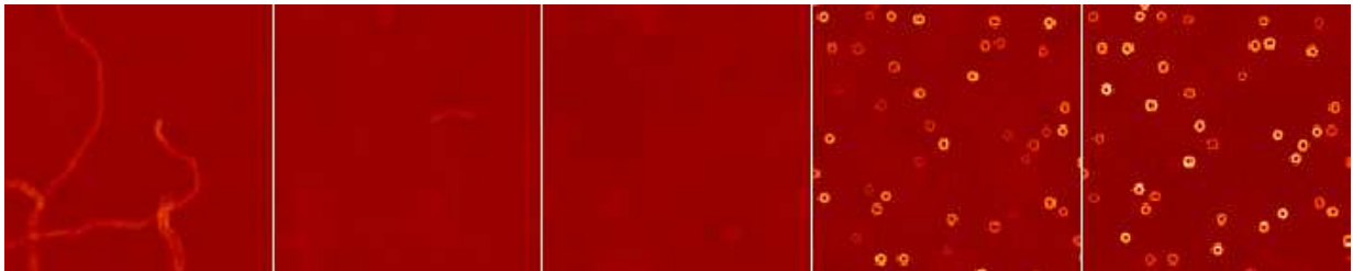
FIG. 2.18 – Solution pour 1% de bruit sans la contrainte de positivité. Hyperparamètre de régularisation gaussienne : 1. Sur la Figure, le noir correspond au minimum d'intensité (soit -6.8 \text{ ph}/\text{pix} ) et le blanc correspond au maximum d'intensité (soit 87.2 \text{ ph}/\text{pix} ).
