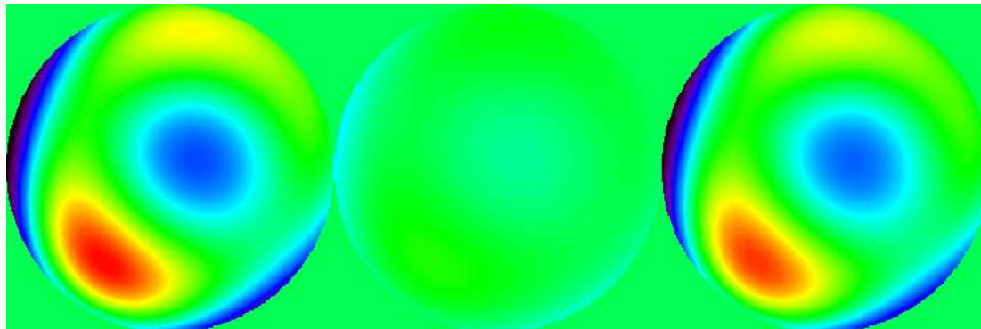
FIG. 3.7 – Comparaison de l'estimation des aberrations par la méthode myope (au centre) et par la diversité de phase 3D (à gauche). La phase vraie est donnée à droite.
