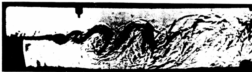
FIG. 4.4 – Développement de la couche cisailée depuis la séparation, cas de la marche. (tiré de Pitz, 1981).
