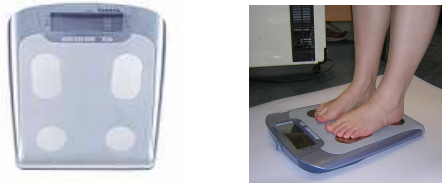
Figure 2.3 : photo du prototype PPI provenant d'une modification du Bodymaster Vision ®
