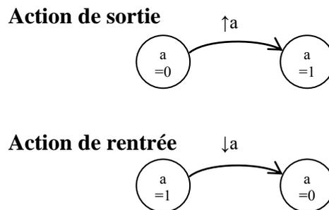
Figure 3.14 : évolution des capteurs en fonction des actions
