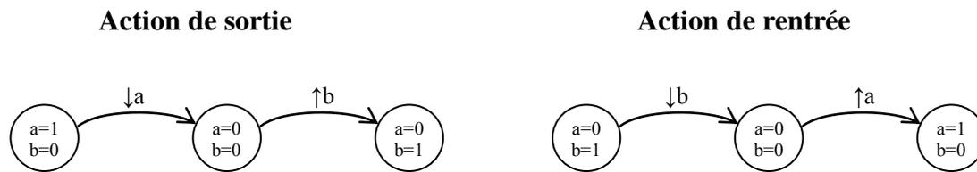
Figure 3.23 : évolution des capteurs en fonction des actions
