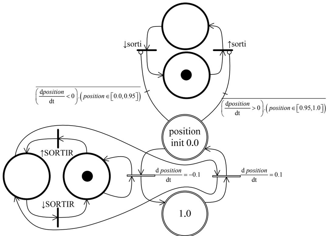
Figure 4.17 : modèle de partie opérative de la chaîne fonctionnelle
