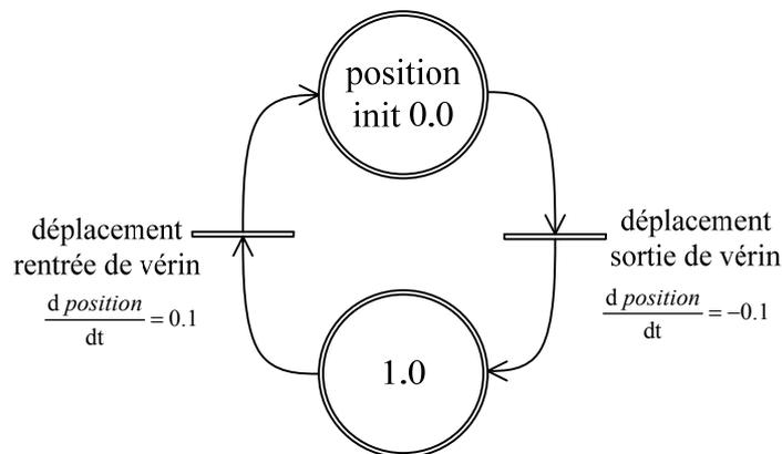
Figure 4.15 : modélisation de l'actionneur
