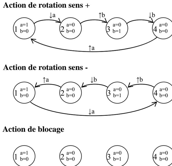
Figure 3.41 : évolution des capteurs en fonction des actions
