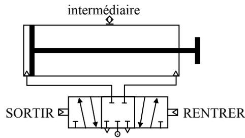
Figure 4.25 : chaîne fonctionnelle « vérin pneumatique avec distributeur à trois positions et un capteur intermédiaire »
