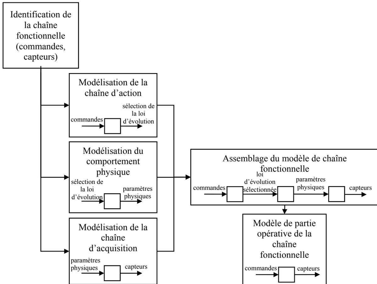
Figure 4.7 : adaptation de la démarche de modélisation aux systèmes hybrides
