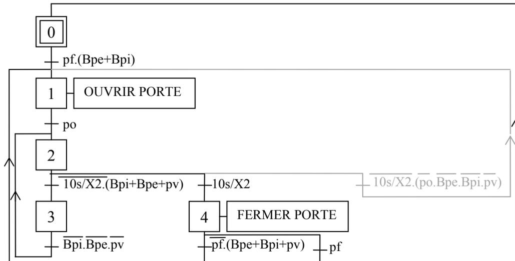
Figure 4.37 : exemple de programme SFC de la porte de garage présentant une instabilité et proposition de correction à apporter
