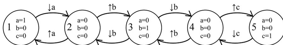
Figure 3.31 : évolution des capteurs en fonction des actions
