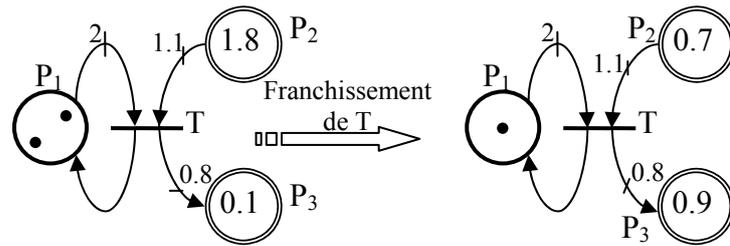
Figure 4.3 : franchissement d'une transition discrète dans un réseau de Petri hybride
