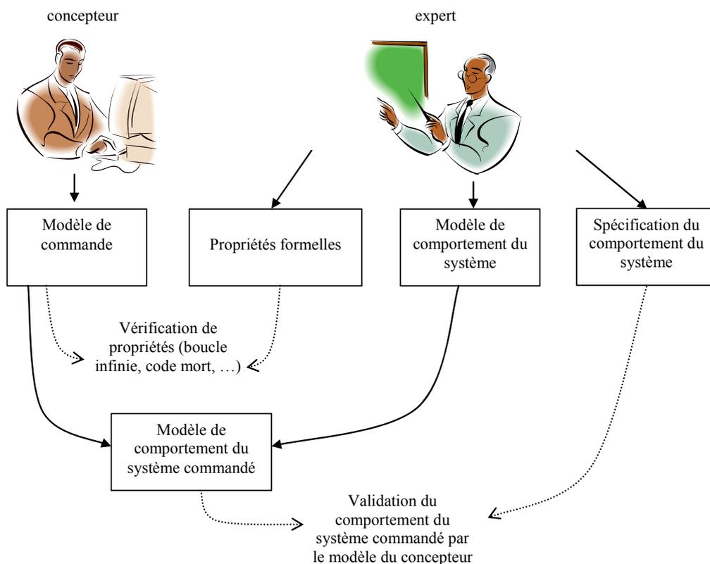
Figure 1.4 : validation de la commande par vérification
