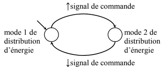
Figure 3.6 : modélisation d'un préactionneur avec une commande monostable
