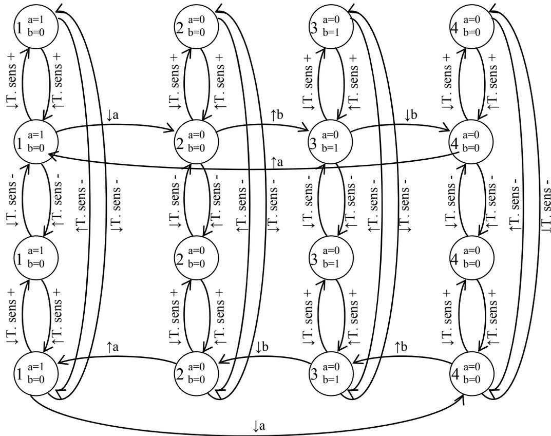
Figure 3.42 : évolution des capteurs en fonction des actions
