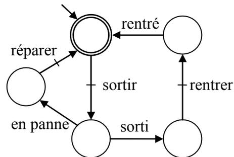
Figure 2.8 : assemblage du modèle de comportement du vérin
