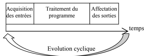
Figure 1.13 : évolutions cycliques de l'automate programmable industriel
