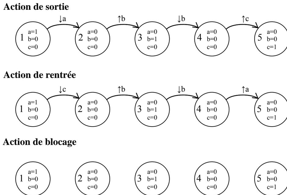
Figure 3.37 : évolution des capteurs en fonction des actions
