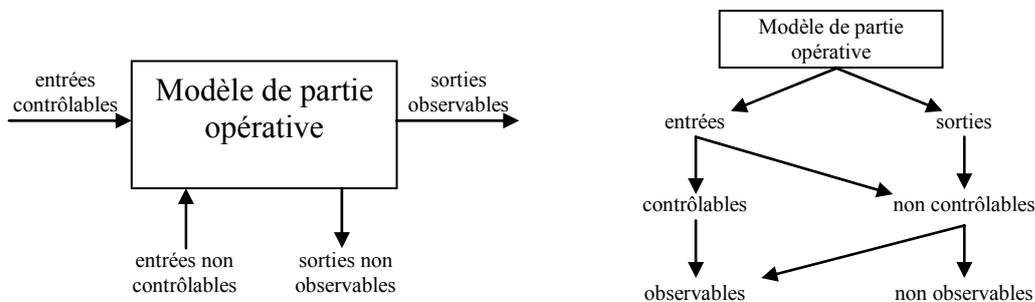
Figure 1.14 : représentation du modèle de partie opérative
