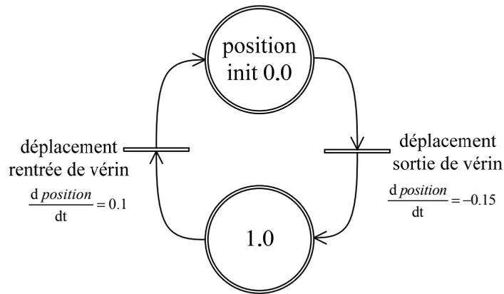
Figure 4.23 : modélisation de l'actionneur
