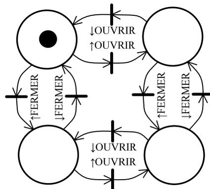
Figure 4.38 : modélisation du préactionneur
