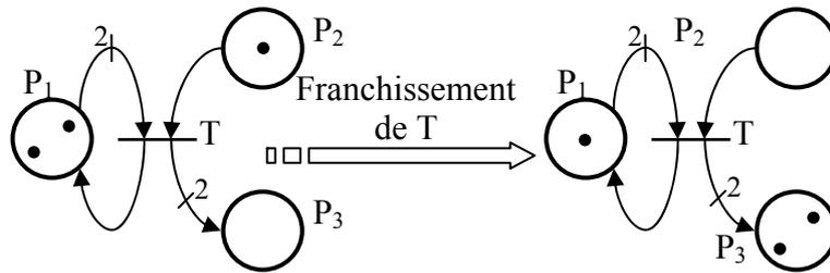
Figure 4.1 : franchissement d'une transition discrète
