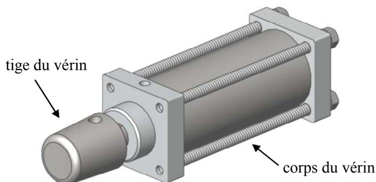
Figure 2.3 : exemple de vérin pneumatique
