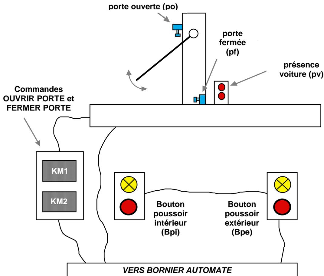
Figure 4.36 : instrumentation de la maquette « porte de garage »
