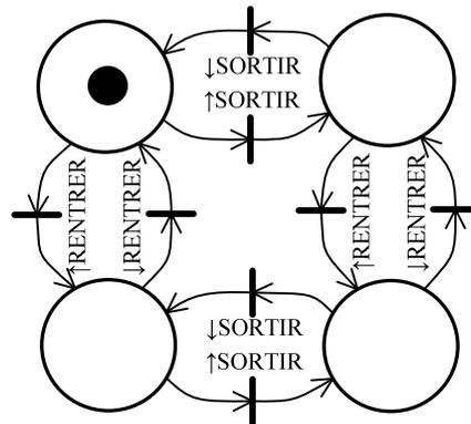
Figure 4.26 : modélisation du préactionneur
