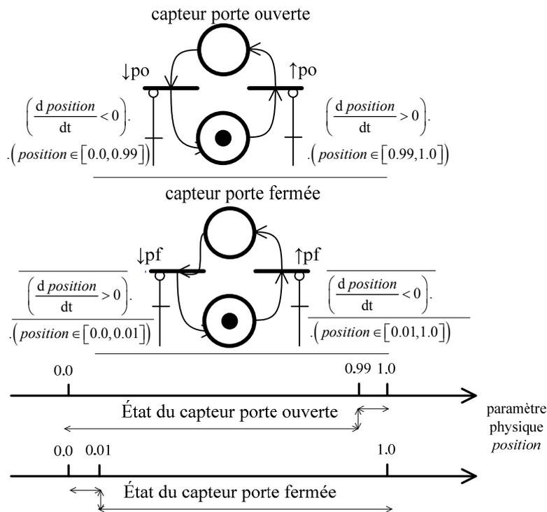
Figure 4.40 : modélisation des capteurs
