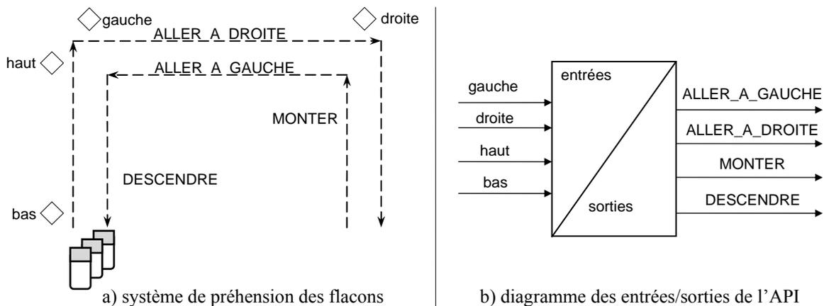
Figure 3.47 : système de préhension des flacons
