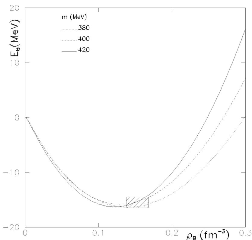
**Figure 8.2** - Énergie de liaison  $E_B$  en fonction de la densité baryonique  $\rho_B$  pour trois valeurs de la masse du quark dans le vide :  $m = 380 \text{ MeV}$  (ligne pointillée),  $m = 400 \text{ MeV}$  (ligne tiretée) et  $m = 420 \text{ MeV}$  (ligne pleine). La zone hachurée représente la zone empirique du point de saturation.
