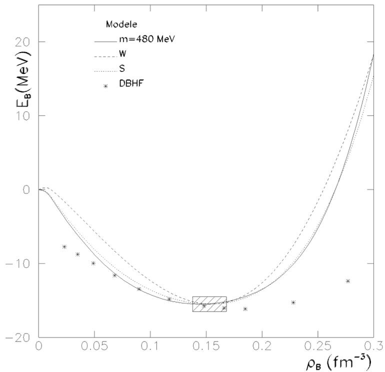
**Figure 5.4** - Energie de liaison  $E_B$  en fonction de la densité baryonique  $\rho_B$  pour : notre modèle avec  $m = 480$  MeV (ligne pleine), le modèle de Walecka **W** (ligne tiretée), le modèle de Song **S** (ligne pointillée) et le résultat du calcul DBHF-BonnA (étoiles). La zone hachurée représente la zone empirique du point de saturation.
