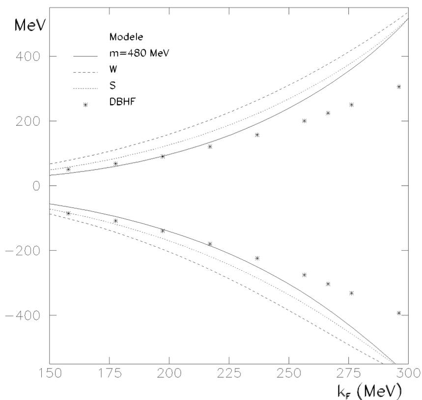
**Figure 5.5** - Self-énergies du nucléon en fonction du moment de Fermi  $k_F$  pour : notre modèle avec  $m = 480$  MeV (ligne pleine), le modèle de Walecka **W** (ligne tiretée), le modèle de Song **S** (ligne pointillée) et le résultat du calcul DBHF-BonnA (étoiles).
