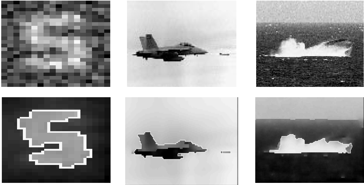
Figure 5 : Images originales (en haut) et images obtenues par un réseau résistif non-linéaire stochastique (en bas). En dépit du niveau de bruit important, l'algorithme permet de combiner filtrage et détection des contours [RN2].
