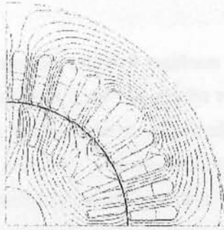
Fig. 9 Machine asynchrone bobiné sur dent avec 5 phases (équiflux du fondamental) [Toliya]
