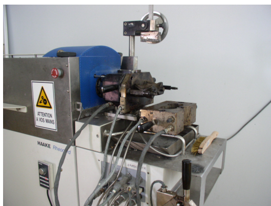
Fig. B- 6. Mélangeur interne HAAKE avec chambre de volume de 300 cm 3
