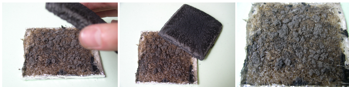
Fig. E- 69. Séparation de la couche protectrice et du matériau en phase de décomposition (exemple à t=400 s.)
