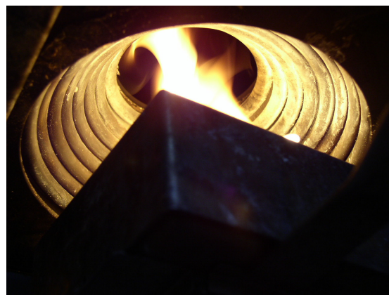
Fig. B- 17. Vue de dessous d'un essai mettant en évidence la résistance en forme de cône
