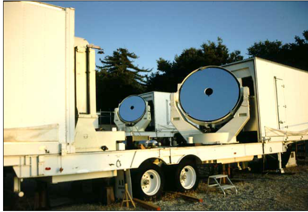
FIG. 1.5 – L'interféromètre hétérodyne ISI (Mont Wilson, Californie).
