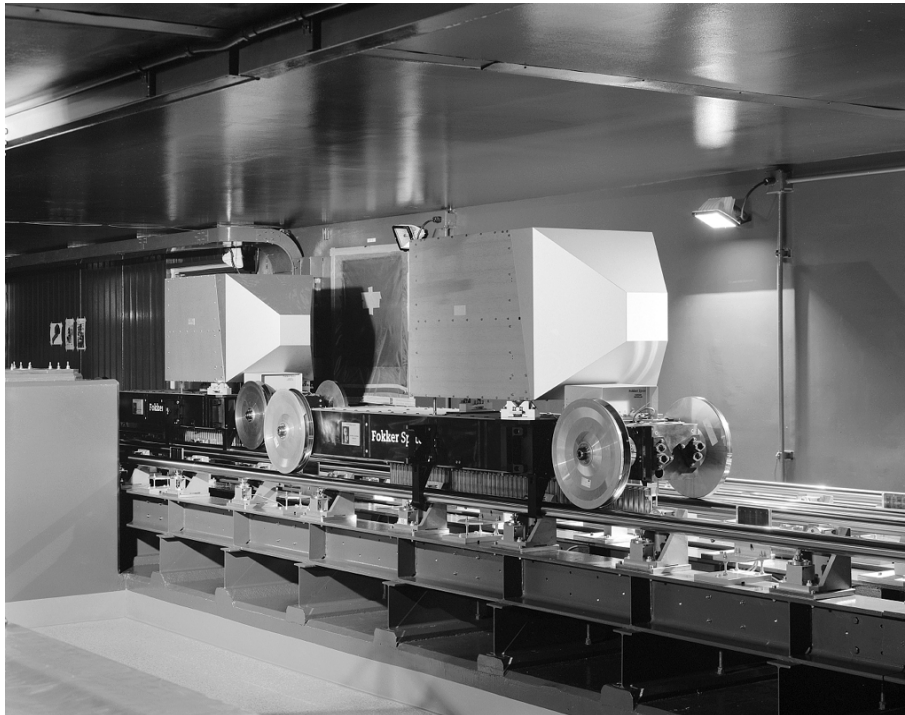
FIG. 3.9 – Deux des charriots mobiles des lignes à retard du VLTI. Leur longueur totale est d'environ 2m.
