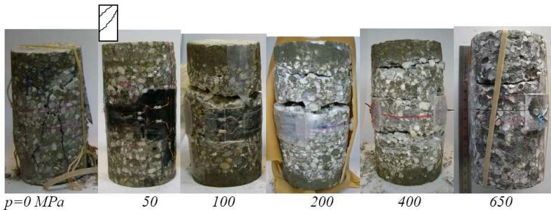
FIGURE 1.15 – Faciès de rupture d’échantillons secs de R30A7 (*in Vu (2007)*)
