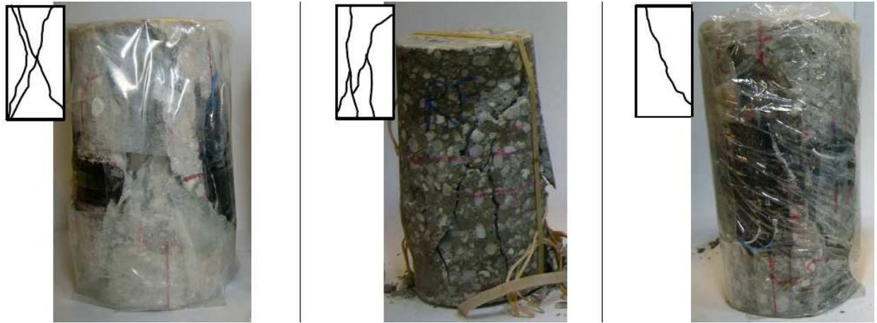
FIGURE 4.32 – Faciès de rupture d'échantillons de béton de granulométrie identique à R30A7 (in Vu (2007))
