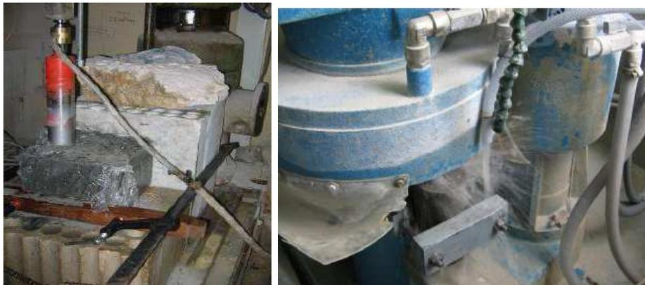
FIGURE 2.16 – Usinage des échantillons de mortier :
