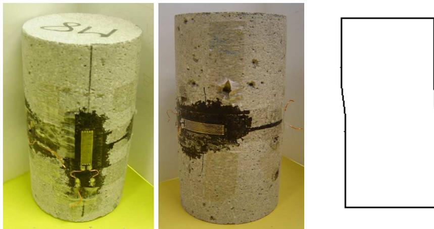
FIGURE 2.40 – Faciès de l'échantillon après essai TXC300
