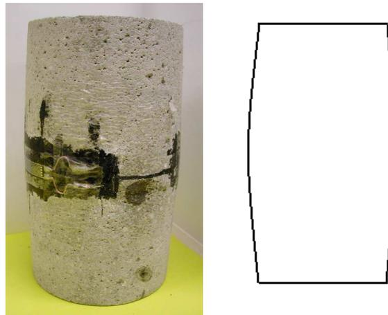
FIGURE 2.39 – Faciès de l'échantillon après essai TXC120
