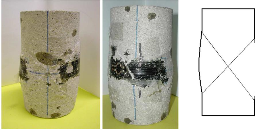
FIGURE 2.38 – Faciès de l'échantillon après essai TXC60
