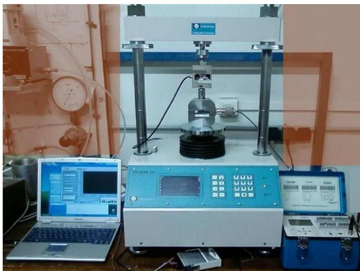
FIGURE 2.3 – Vue d'ensemble de la presse Tri-Scan
