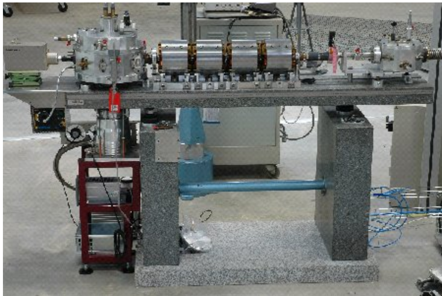
Figure 4.4 : La ligne microfaisceau avec : (à gauche) la chambre d'analyse sous vide, (au centre) les 4 quadrupôles permettant la focalisation du faisceau et (à droite) la chambre contenant les collimateurs d'ouverture.
