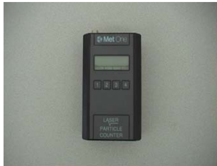
Figure II.6 : Compteur de particules MetOne 227 A
