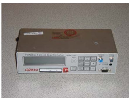
Figure II.7 : Compteur de particules GRIMM 1.108
