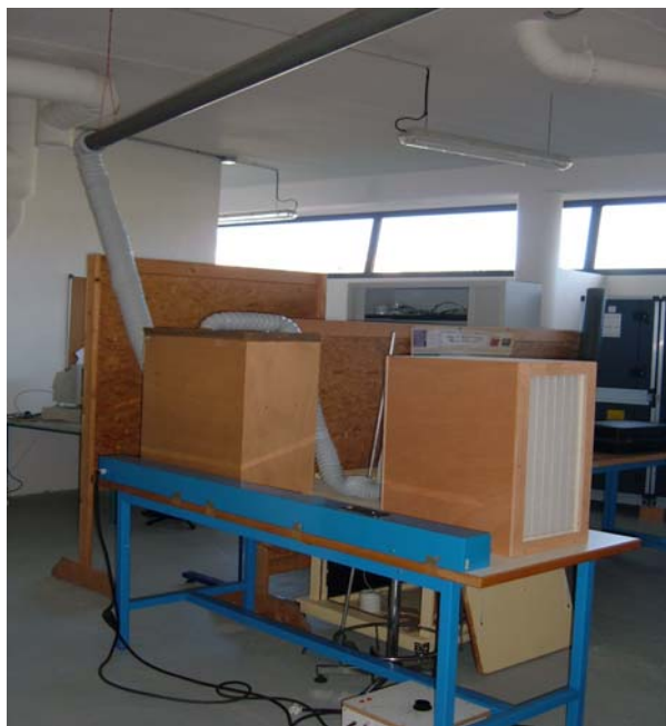
Figure II.15 : Système VMC avec filtre intégral
