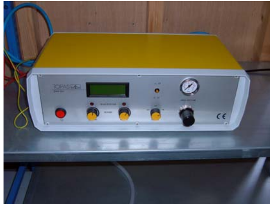
Figure II.3 : Neutralisateur de particules TOPAS EAN 581
