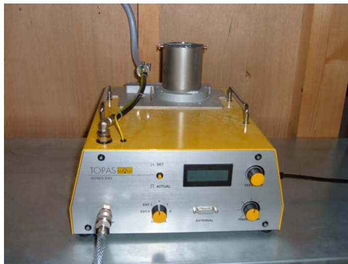
Figure II.1 : Disperseur de particules TOPAS SAG 410
