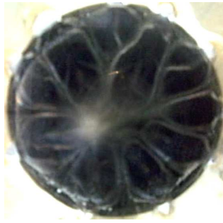
Figure IV.16 : Zone de rupture par séparation due à l'introduction de l'air ambiant dans un contact disque /plan.
