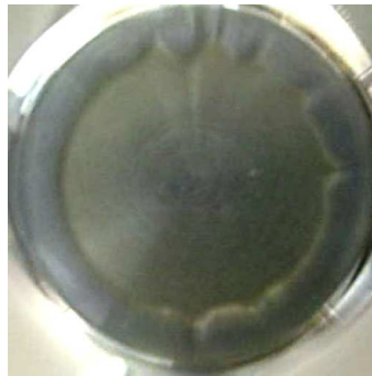
Figure IV.20 : Visualisation de la zone de rupture par séparation obtenue à 21 Hz dans un contact sphère/plan.
