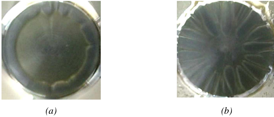
Figure IV.25b: Influence de la fréquence des oscillations sur la forme de rupture par séparation dans un contact sphère/plan (a) 21 Hz (b) 30 Hz
