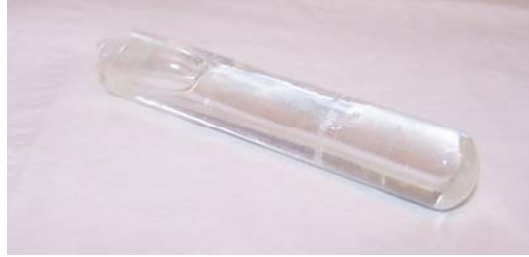
Figure 11 : Photographie d'un barreau de verre (Ga 2 S 3 ) 25 – (GeS 2 ) 50 – CsCl 50 .
