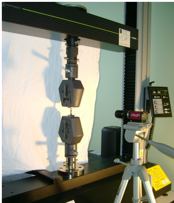
Figure 3.1 – Illustration du dispositif de mesure de déformation sans contact.
