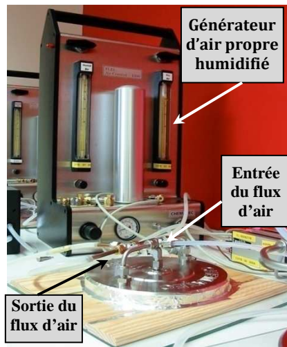
Figure 7 Echantillonnage par la cellule FLEC®
