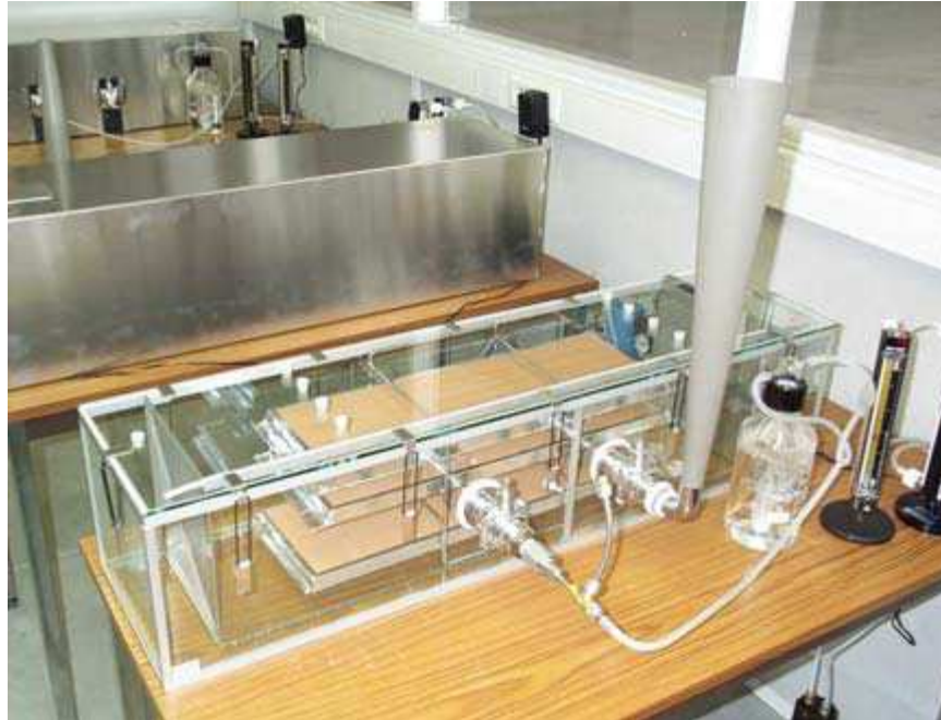
Figure 6 Photo d'une chambre d'essai d'émission [82]
