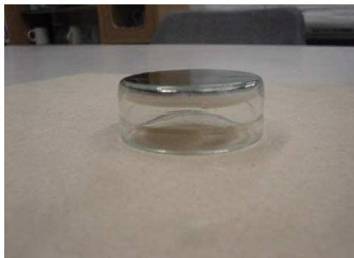
Figure 10 Echantillonnage à flux passif (PFS) de COV [90]
