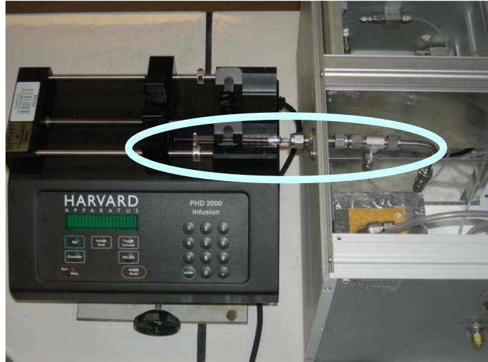
Figure 5 Photo du nouveau dispositif de génération de gaz étalon
