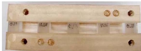
Figure 49: Guide d'ondes rectangulaire avec inserts diélectriques.
