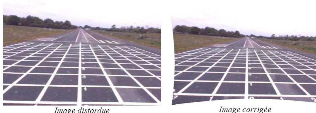
FIG. 4.6 – Résultat de la correction de la distorsion.
