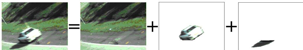
FIG. II.2 – Décomposition des éléments d'une scène. La scène est constituée de l'environnement lié à la route (fixe), du véhicule (mobile) et de son ombre (mobile également).
