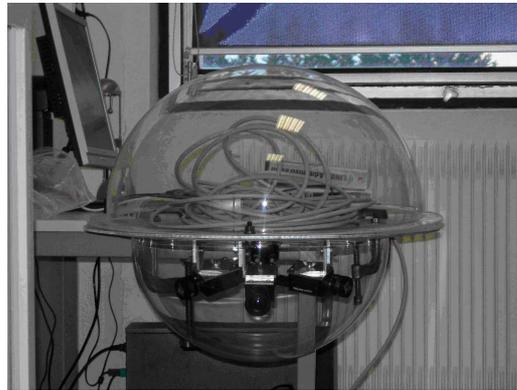
FIG. 1.23 – Photos du chaînage des trois caméras dans leur bulle étanche.
