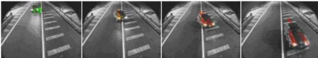
FIG. 1.14 – Les couleurs des trajectoires définissent les comportements des véhicules : Normal en vert, Alerte en orange and Alarme en rouge.
