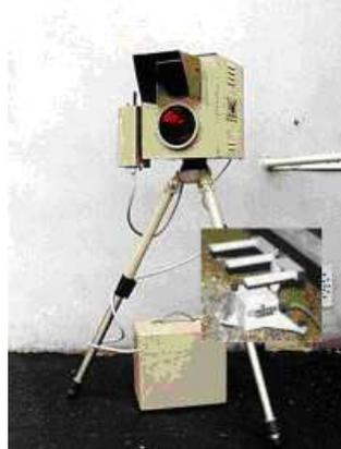
FIG. 1.9 – Barrière photoélectrique triple utilisée en Allemagne pour la mesure de vitesse.
