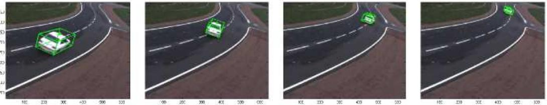
FIG. 4.19 – Images de suivi d'un véhicule pour lequel un conducteur effectue de fort coup de volant ( $\pm 150$ ).
