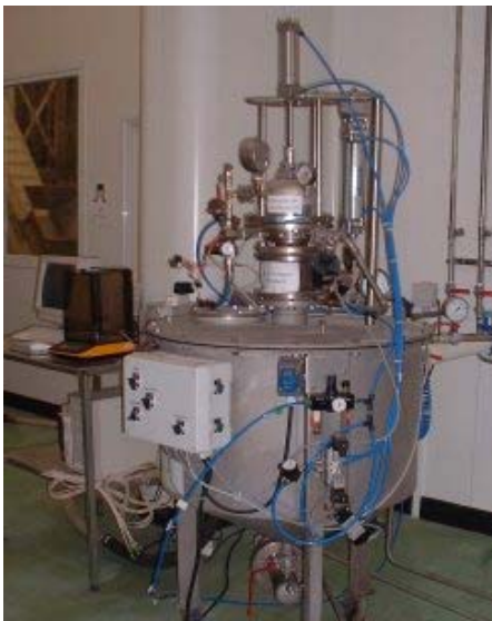
Figure III-12 Schéma du réacteur DDS (1-cloche; 2-base fixe de la chambre de traitement; 3 : système de fermeture; 4-vanne de détente; 5- vérin; 6- manomètres; 7- entrée de vapeur; 8- entrée de gaz; 9-entrée d'eau dans la double enveloppe; 10- sortie d'eau dans la double enveloppe; 11- vers la pompe à vide)
