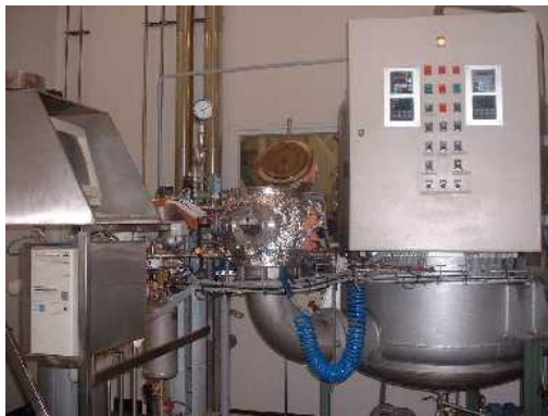
Figure III-10 A gauche : Photos DIC-MP, A droite : présentation schématique du réacteur DIC utilisé (1: Chambre de traitement; 2: valve de détente abrupte; 3: Réservoir à vide; A: générateur de vapeur; B: condenseur; C: pompe à vide).
