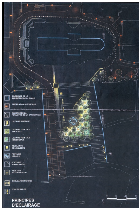
Fig. 5.60. : Plan d'éclairage directement réalisé à partir du plan d'ensemble paysagiste (Anne Bureau/Clermont Ferrand)
