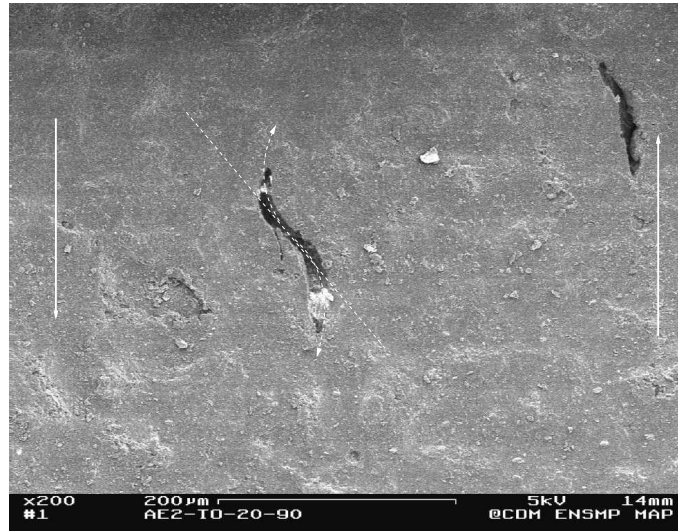
Figure III.54 : Bifurcation des fissures courtes sur éprouvette AE2 lors d'un essai de torsion 20-90°.
