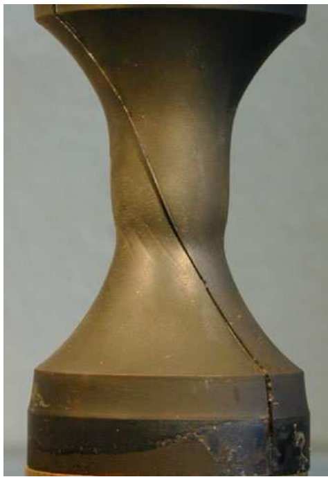
Figure II.8 : Striction lors d'un essai de traction compression et torsion statique.
