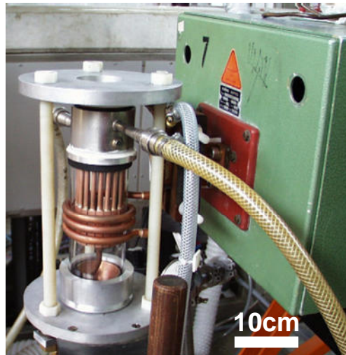
Figure II-1 Four à induction en creuset froid servant à l'obtention de l'alliage
