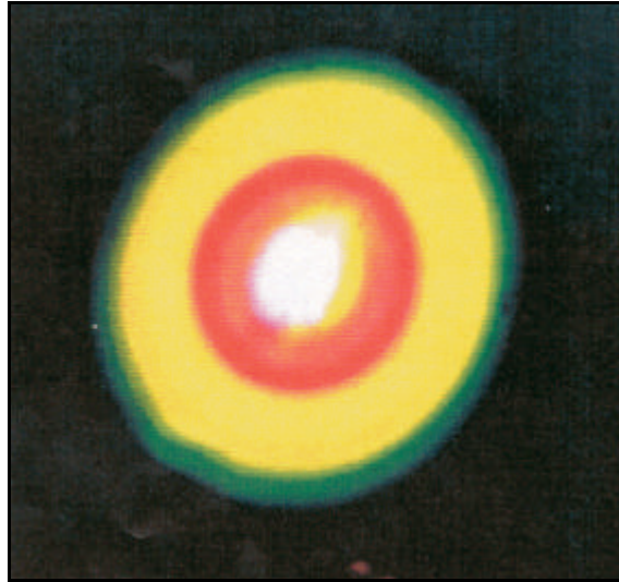
Figure V-6. Photographie de l'émission conique d'un filament 7 . La tache blanche au centre correspond au filament.
