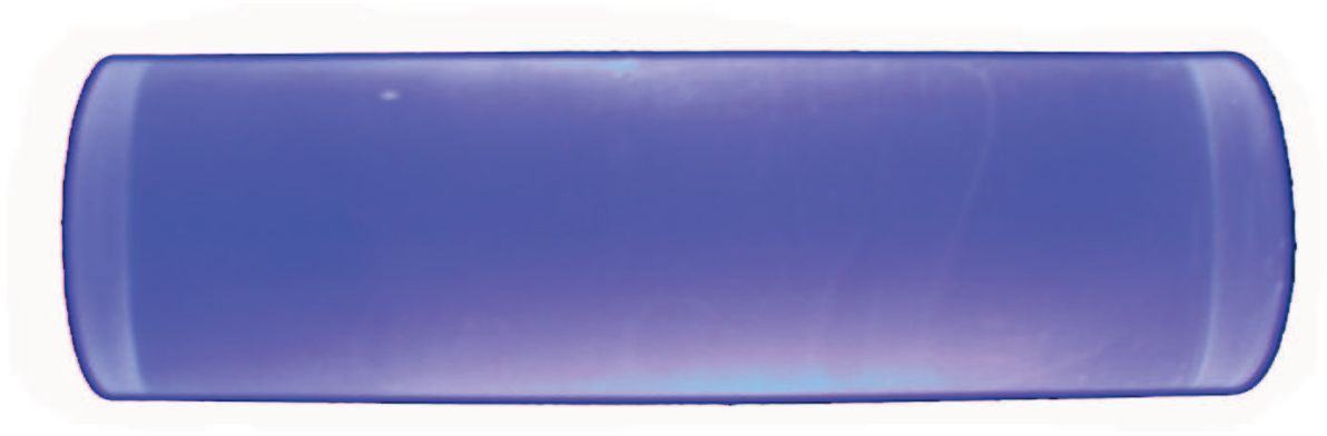
FIG. 4.10: Photographie d'un scintillateur plastique illuminé par une lampe U.V.
